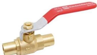
Al estar fabricadas por estampación en caliente, frente a otras válvulas obtenidas por fundición, conseguimos la ausencia de poros y una mayor resistencia mecánica.
