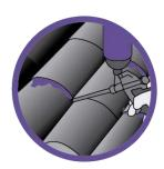
OLIVÉ PU-49 TEJAS se utiliza en el sector de la construcción, especialmente para la FIJACIÓN de tejas, evitando el uso de morteros, clavos o ganchos.
