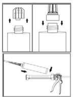
Desenroscar el tapón del cartucho y fijar firmemente la boquilla mezcladora.
