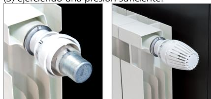
Si observa dentro del cabezal, verá una señal negra cerca del bulbo. Compruebe que dicha señal coincide siempre con la muesca del manguito separador.
